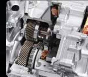
Hauptzweck des Verbrennungsmotors ist die Stromerzeugung. Dies geschieht meist bei höheren Geschwindigkeiten, da er in diesem Bereich sehr effizient arbeitet. Die kompakte, mit dem Verbrennungsmotor verbundene Überbrückungskupplung überträgt für eine sparsame Fahrt bei Bedarf außerdem Kraft vom Verbrennungsmotor auf die Räder.
